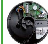
Integriertes Drehzahl Potentiometer
